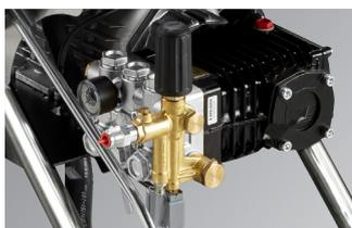
Nouvelles pompes CL3.8 et CL 6.0 auto-amorçantes à trois pistons en céramiques intégrale, double visière à huile et tête en laiton. Nouvelle vanne de régulation de pression à bride L3.1, passages internes redimensionnés pour assurer son bon fonctionnement même dans des conditions de débits de fonctionnement élevés
